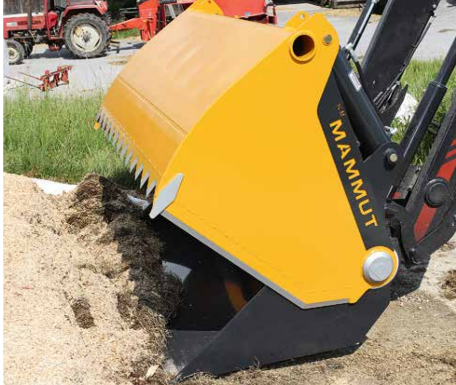
△ Die neue Schneidschaufel aus der mittleren Baureihe M erledigte ihre Arbeit in Mais und Sandwichsilage einwandfrei. Für Grassilage ist sie nicht das optimale Gerät.
