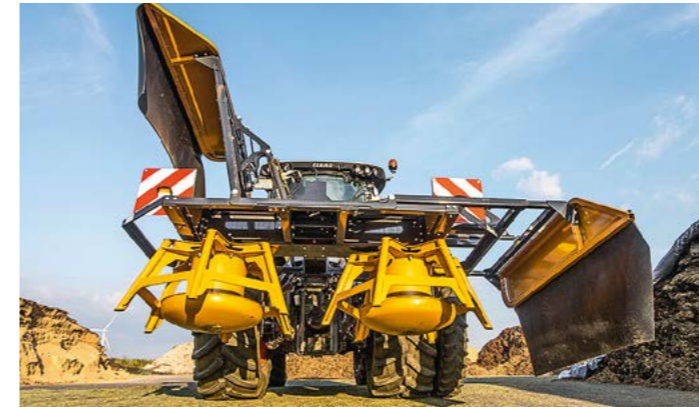
Beide Anbauböcke sind mit zwei Schwenkzylindern (Pfeile) robust ausgelegt.
