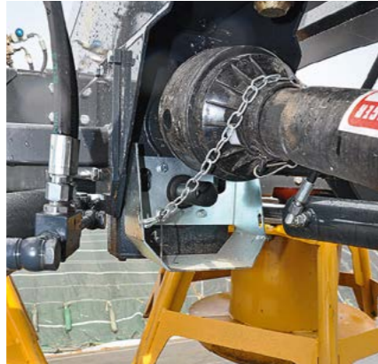
Mit dem optionalen Wendegetriebe ist der Betrieb im Front- und Heckhubwerk möglich.
