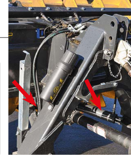
Beide Anbauböcke sind mit zwei Schwenkzylindern (Pfeile) robust ausgelegt.
