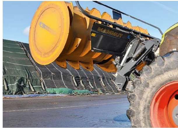
Gut bei steilen Futterstöcken: Der Trommelverteiler hebt im Fronthubwerk einen halben Meter höher aus.
