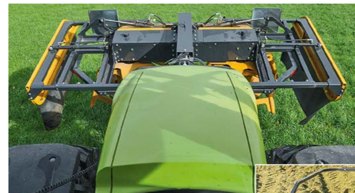
Beide Siloverteiler ragen gleich weit nach vorne aus. Für die Sicht bei der Arbeit ist dies gut, nicht aber für die Straßenfahrt.
